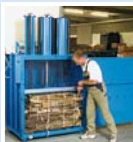
*O material prensado é preso a uma altura normal de trabalho sem recorrer a ferramentas.*
